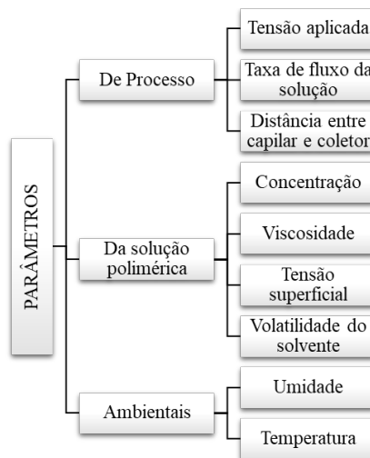
FIGURA 3 — PARÂMETROS INFLUENCIADORES DO PROCESSO DE ELETROFIÇÃO
